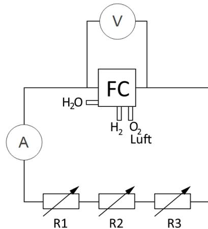
**Abbildung 3:** Schaltplan zur Aufnahme der Kennlinie einer PEM-Brennstoffzelle
