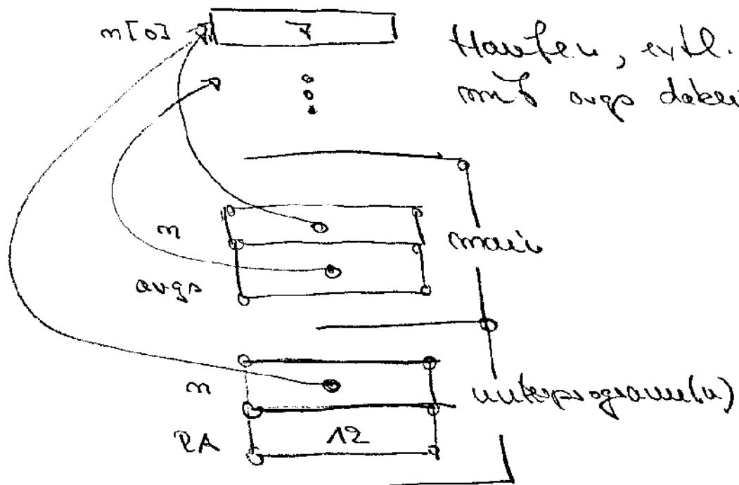
An den formalen Parametern, einer Referenzvariable, wird die Wert von der Referenzvariable  $m$  übergeben. Im unterprogramm( $n$ ) wird das  $m[0]$  im Haupte geändert.
