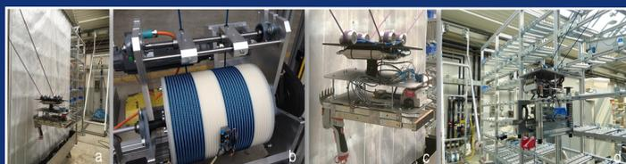
Abb. 2 Nicht-redundant abgespannter Seilroboter
