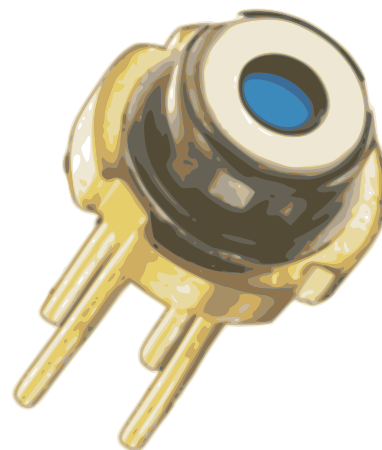
Abb. 1.1: schematisiertes Abbild eines VCSEL-Bauelements (nach [1])
