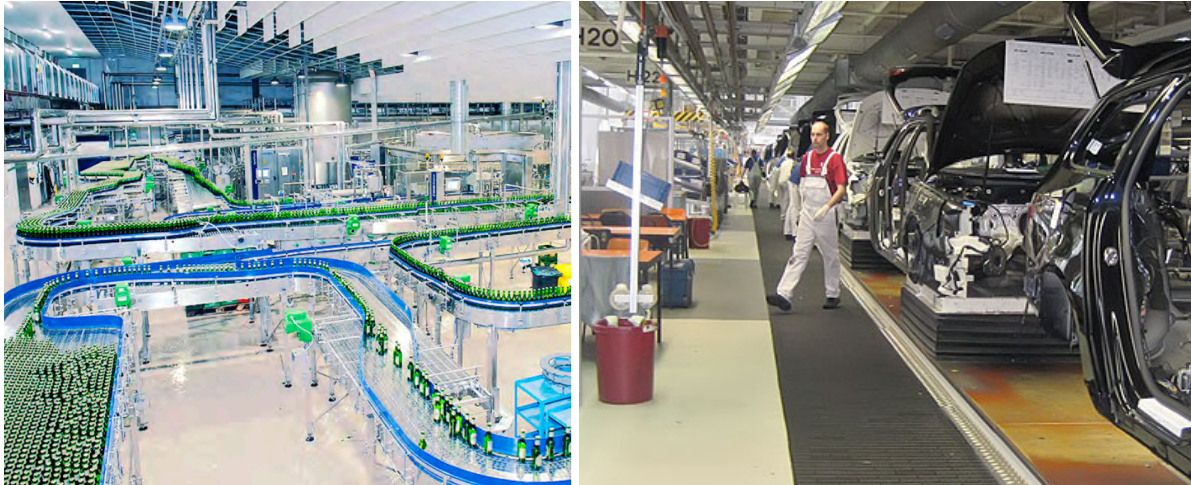
Abbildung 1: Getränkeförderanlage (links) und Werker-Mitfahrband (rechts) [Krones, VW]
